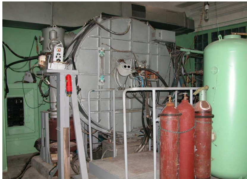
Рисунок 1.3.2 – Установка ВГУ-2М для відцентрового плазмового розпилення електроду, що обертається.
