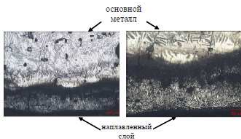
Рисунок 3.3 Мікроструктура основного матеріалу та наплавленого шару товщиною 250–300 мкм[23].
