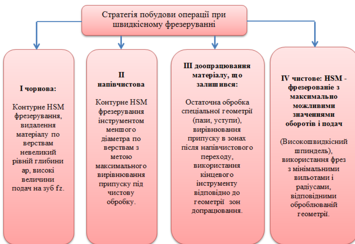
Рисунок 1.7 - Стратегія побудови операції при швидкісному фрезеруванні
