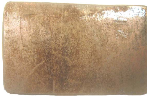
Рисунок 3.17 – Зовнішній вигляд зразків сталі 03X3CЮ після випробувань на жаростійкість при температурі 400°C впродовж 300 год
