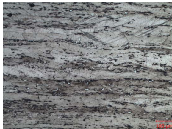
Рисунок 3.26 -Мікроструктура сталі 03X3CЮ в нагартваному стані без термічної обробки (x100)
