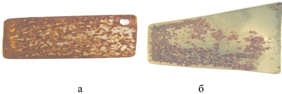
Рисунок 3.13 – Зовнішній вигляд зразків після випробувань у атмосфері міського середовища протягом 5000 год
