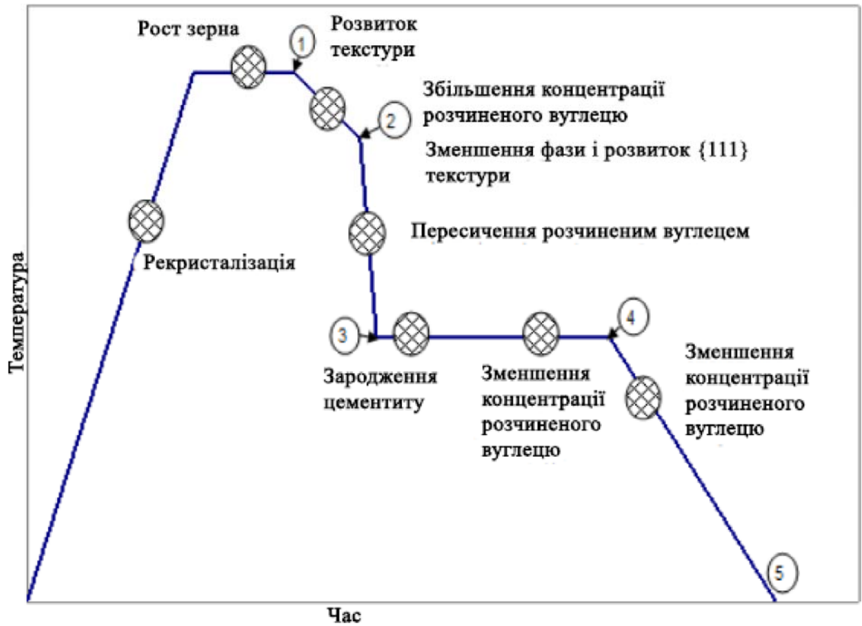
Рисунок 1.24 – Структурні зміни й зміна змісту розчиненого вуглецю в процесі безперервної термічної обробки
