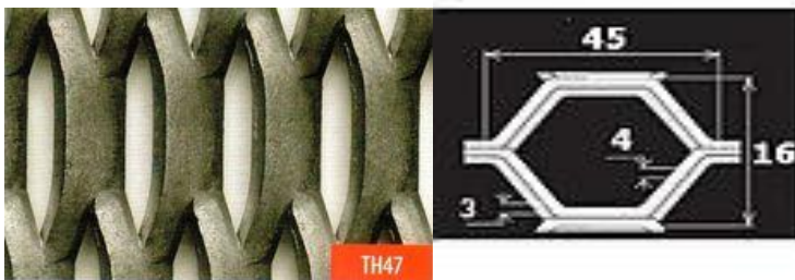
а – загальний вигляд; б - шестикутна форма вічка ТС Е45/16х4х3/1000х2000. Рисунок - просічно-втяжний титановий лист
