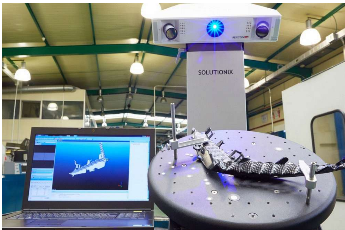
Рисунок 3.4 – Використання 3D сканерів для контролю малих складнопрофільних деталей [13]
