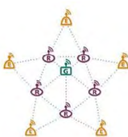
Рисунок 1.7 – Гібридна мережа i-Bean (E - кінцева точка, R - роутер, G - центральний шлюз) [8]
