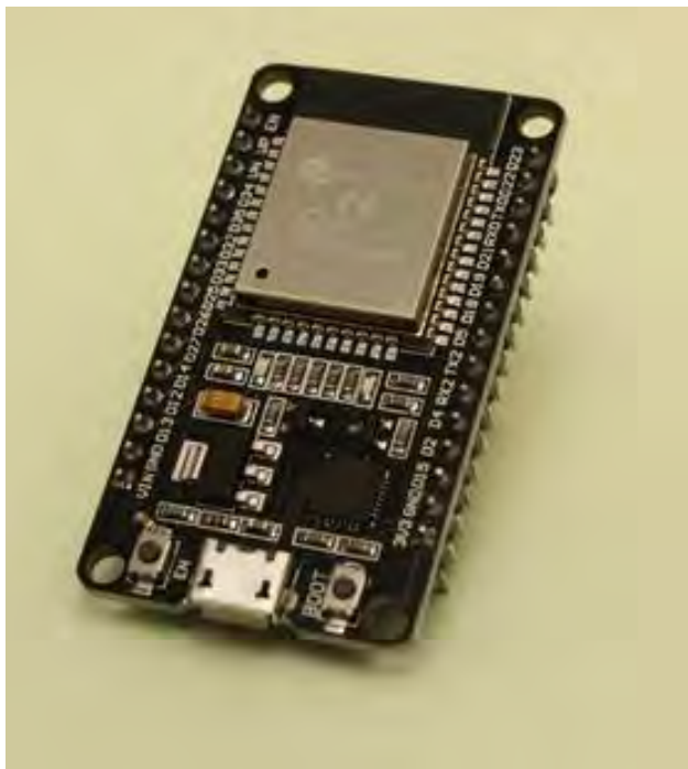
Рисунок 5.5 - Плата Devkit з модулем ESP32-WROOM (роутер)
