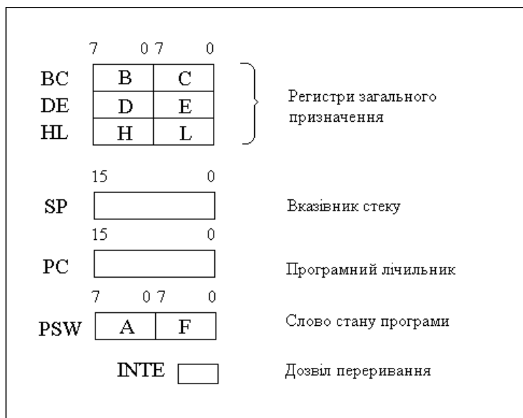
Рисунок 2.2 - Блок регістрів мікропроцесора
