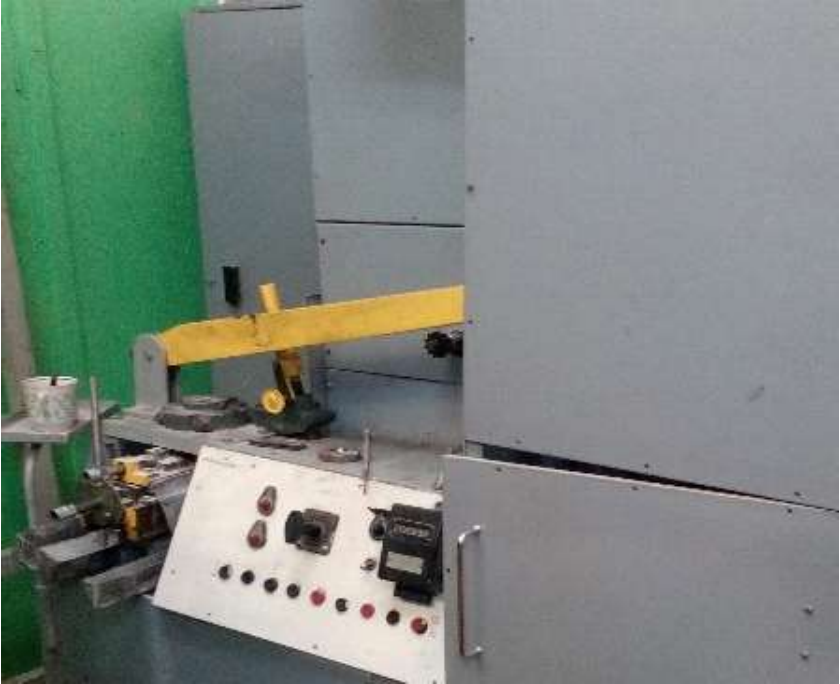
Рисунок 2.9 – Лабораторний стенд для проведення випробувань на зносостійкість.
