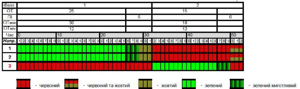
Рисунок 1.15 – Циклограма роботи світлофорів на перехресті
