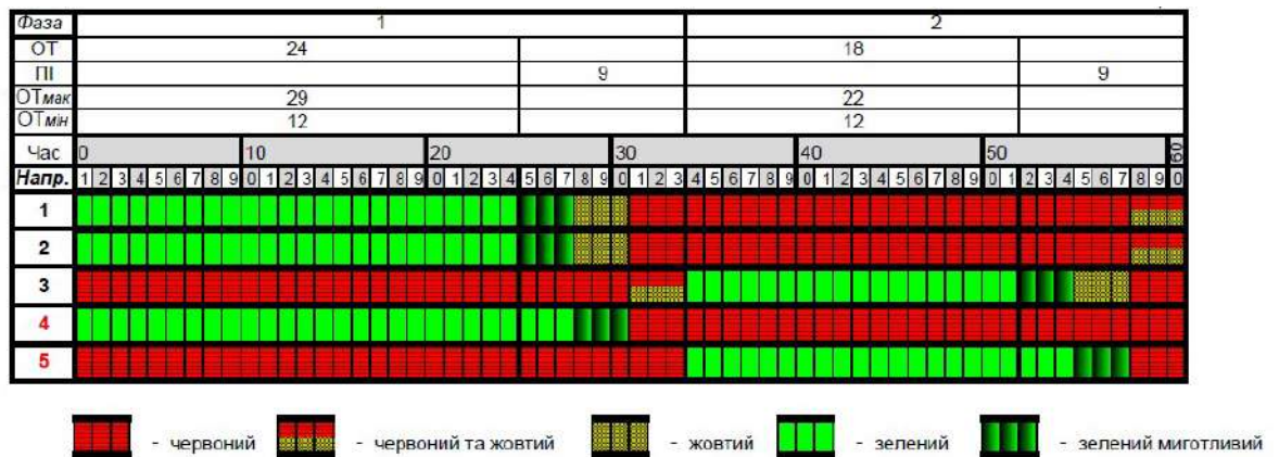
Рисунок 1.13 – Циклограма роботи світлофорів на перехресті
