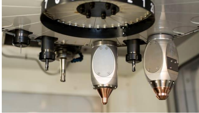
Рисунок 5.5 – Інструменти AMBІТ поруч із звичайними субтрактивними інструментами в інструментальному магазині
