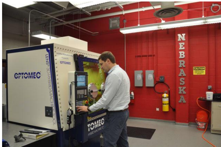
Рисунок 5.6 – Гібридна машина Optomec для виробництва біорозкладних медичних імплантатів
