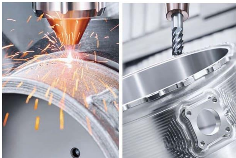
Рисунок 5.1 – Виготовлення деталей за допомогою гібридного виробництва
