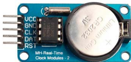
Рисунок 7.1 - Модуль годинника реального часу DS1302
