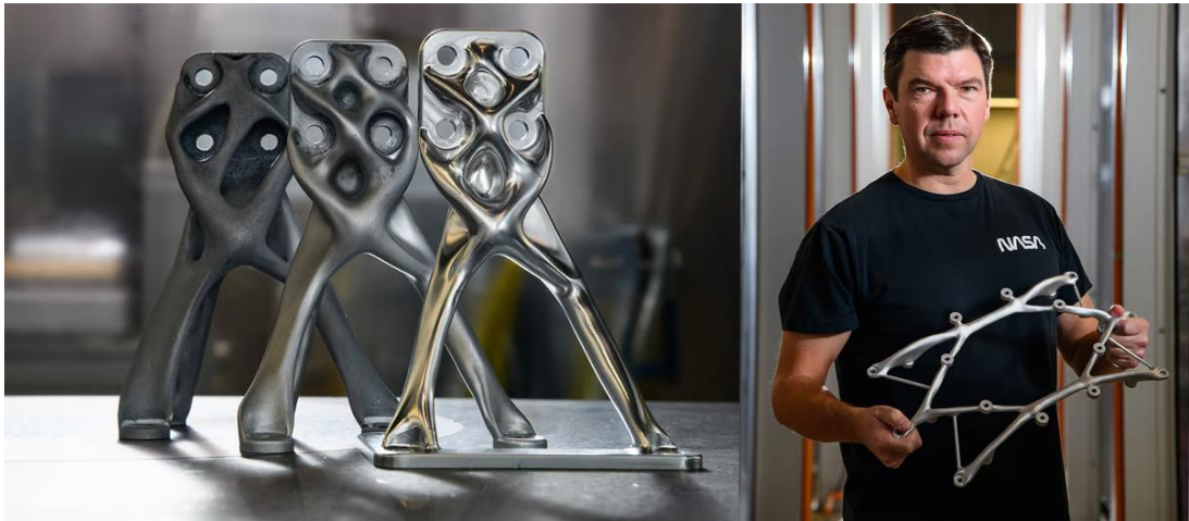
Рисунок 1.2 – Деталі космічних апаратів NASA виготовлені з використанням генеративного проектування. Райан Макклелланд, інженер-дослідник NASA, демонструє кріплення, розроблене з використанням генеративного проектування (б) [2]
