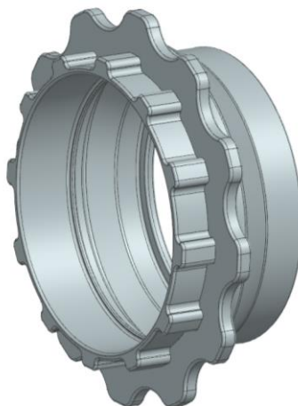
Рисунок 4.3 – Заготовка, отриманна литтям по витоплюваним моделям
