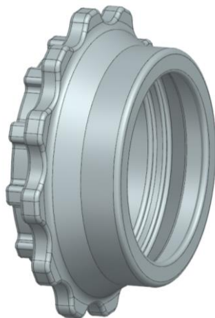
Рисунок 4.2 – Заготовка, отриманна литтям в піщані форми
