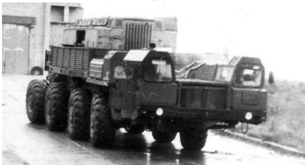
Рисунок А.6 – Шасі Е79085 з рульовим керуванням 1-2-3-4 : a – вид збоку; б – вид спереду
