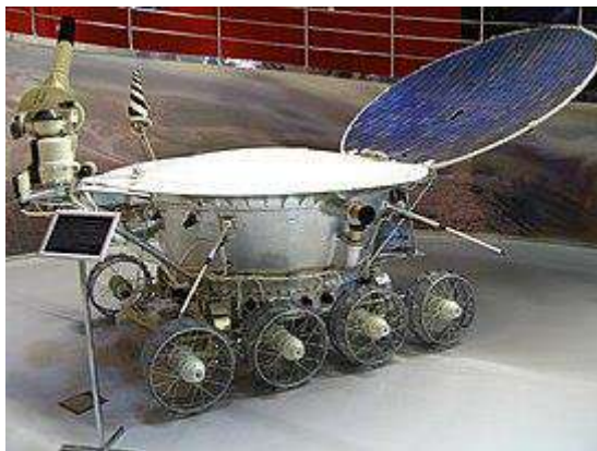
Рисунок Г.2 – «Луноход-1» (Апарат 8ЕЛ № 203). НПО Лавочкина (головне підприємство), ВНІ Трансмаш (шасі апаратів, що спускаються – 1963 рік). Маса об'єкта m_a=756 кг.
