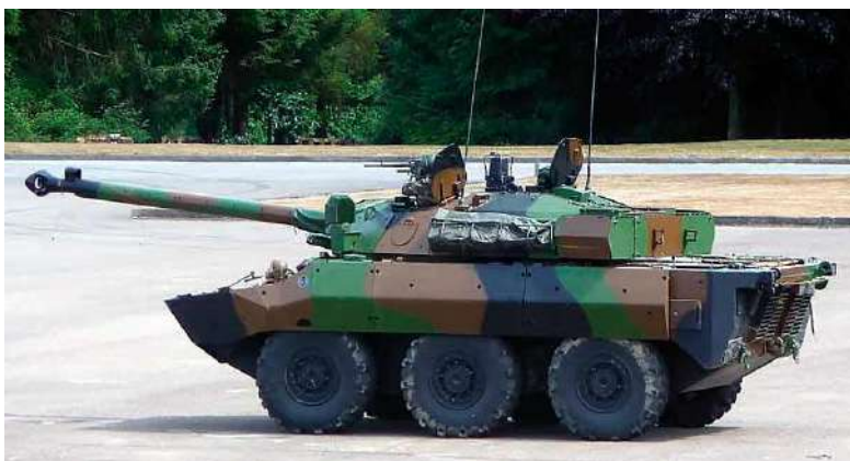
Рисунок Г.3 – Колісна броньована машина AMX-10RC AVHVS GIAT з системою рульового керування 0=0=0 (Франція, розробка 1970 року). Двигун Hispano-Suiza HS-115 багатопаливний (1981–1985); Baudouin Diesel Model 6F11 SRX (поточний) HS-115: 250 hp (186 kW). Максимальна швидкість V_{max}=85 км/год. Маса машини m_a=15,8 т.
