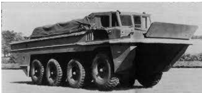
Рисунок Г.1 – Амфібійний вантажний транспортер Террапін Mk.I (Великобританія, фірма Morris). Виробництво 1943–1944 (500 од). Двигун – 2 x Ford V8, N_e=190 л.с. (140 кВт). Мінімальний радіус повороту R_{min}=2,32 м. Максимальна швидкість V_{max}=24 км/год (по воді 8 км/год). Маса автомобіля m_a=7 т.
