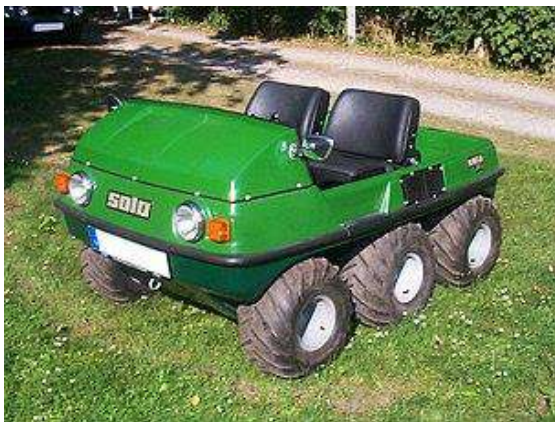
Рисунок Г.4 – Відкритий всюдихід-амфібія Solo 750 німецької компанії Solo Kleinmotoren GmbH (1971–1981). Максимальна швидкість V_{max}=48 км/год. Двигун – одноциліндровий V_h=0,43 л, N_e=15 кВт. Маса автомобіля m_a=0,45 т.
