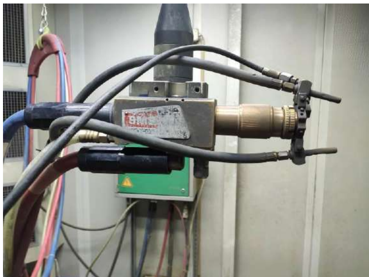
а – Плазмотрон, б – інтерфейс керування Рисунок 3.5 – Пальник та система керування
