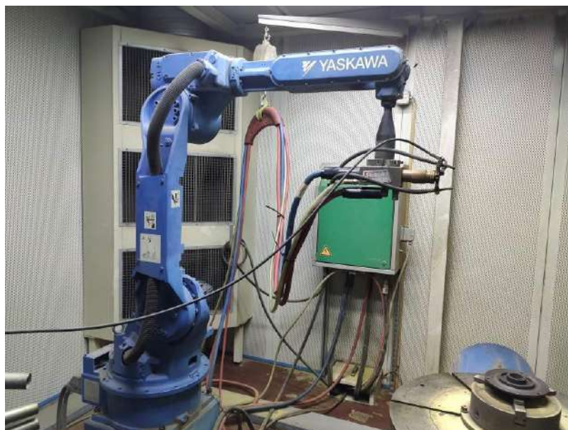
Рисунок 3.2 – Промисловий робот Yaskawa Motoman GP12
