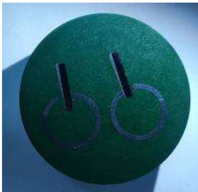
Рисунок 4.3 – Зовнішній вигляд шліфів (без травлення)
