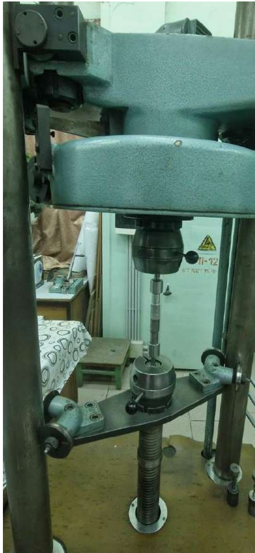
Рисунок 4.7 – Клейовий зразок в розривній машині
