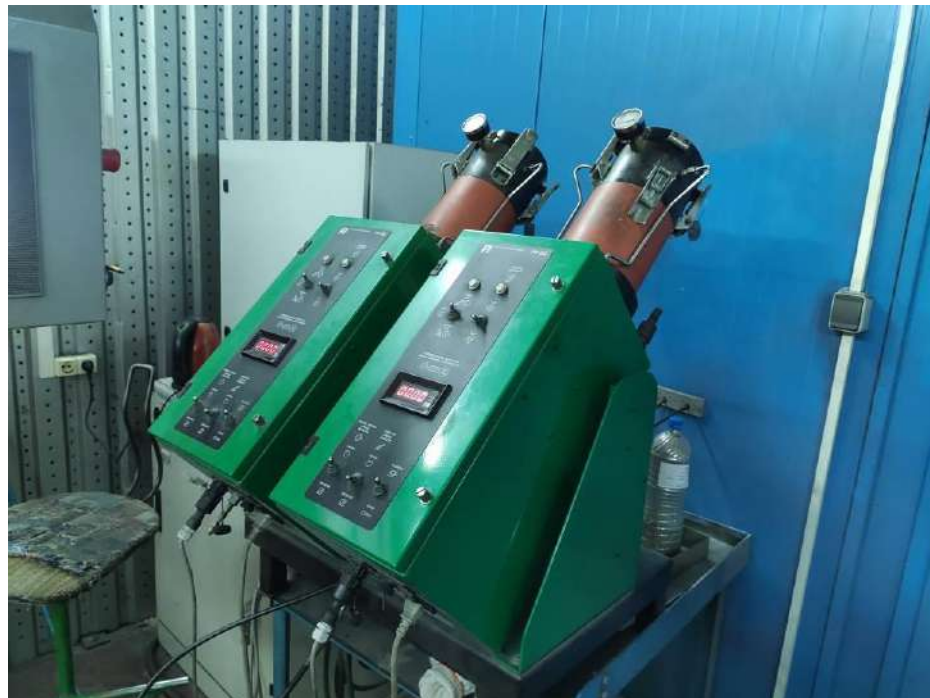
Рисунок 3.6 – Порошковий живильник FST PF-50
