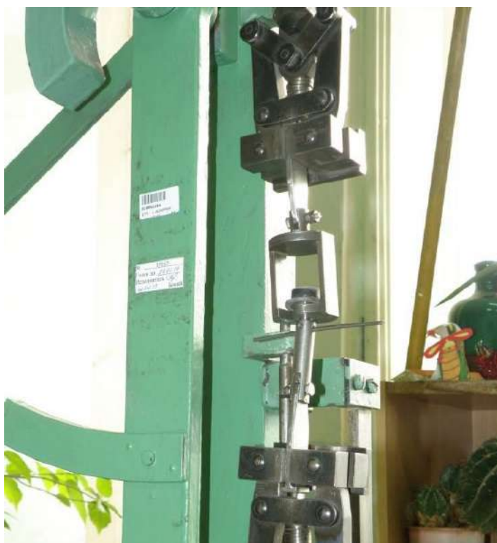
Рисунок 4.8 – Штифтовий зразок в машині для випробувань
