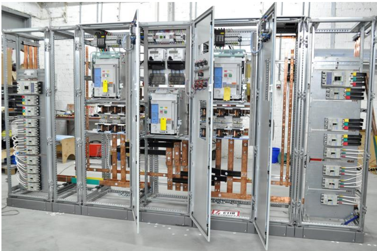
Рис 1.- Розподільний пристрій (РУ) або головний розподільний щит (ГРЩ) Основні функції та особливості РУ-0,4 кВ або головного розподільного щита (ГРЩ)
