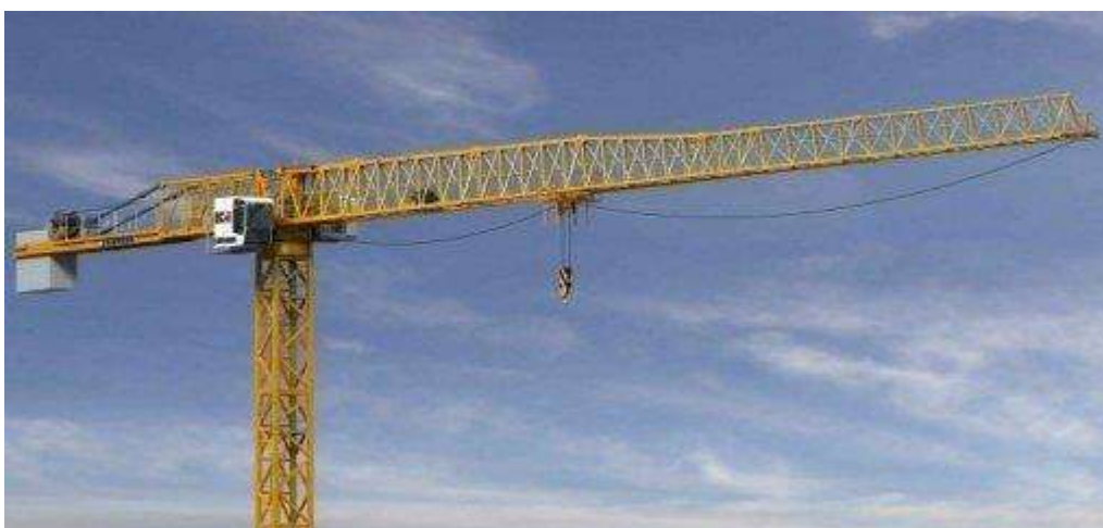
Рисунок 10.29 - Баштові крани без оголовка (молотоподібні, «топлес») при обслуговуванні робочих зон
