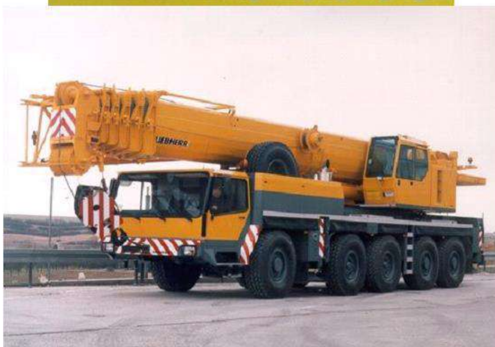
а) маневреність; б) транспортне положення Рисунок 11.5 – Кран підвищеної прохідності LTM150/1 вантажопідйомністю 150 т
