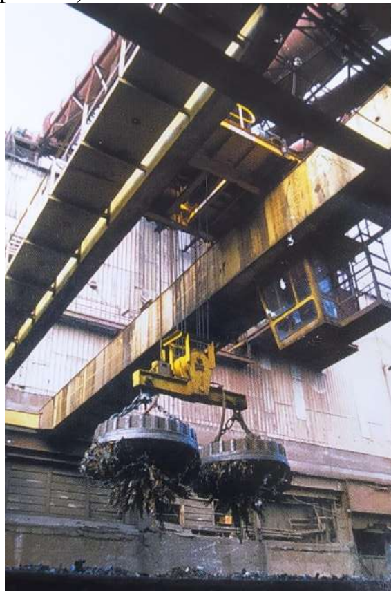
Рисунок 3.3 – Парномагнітний спеціальний мостовий кран на перевалці скрапа
