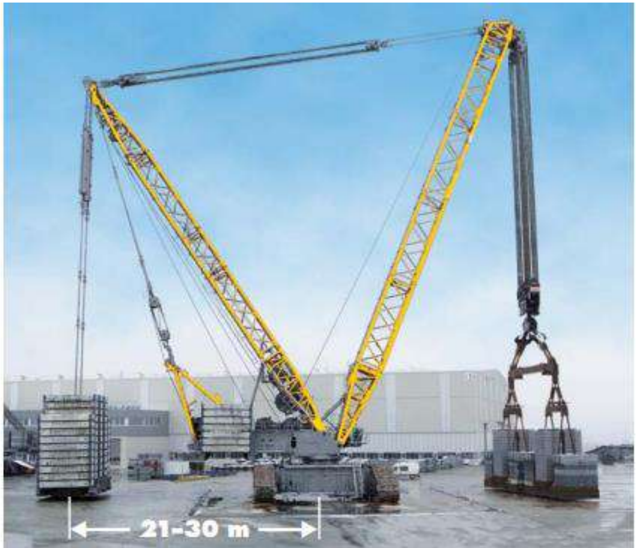
Рисунок 12.7 - Безступінчаста зміна вильоту дерік-стріли
