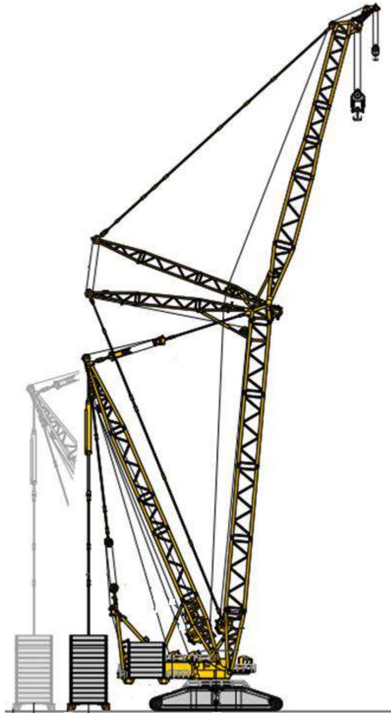
Рисунок 12.13 – Гусеничний кран з ґратчастими багатоелементною стрілою з гусаком та деріком
