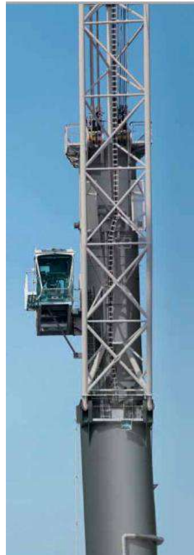
Рисунок 9.30 - Трубчаста конструкція башти
