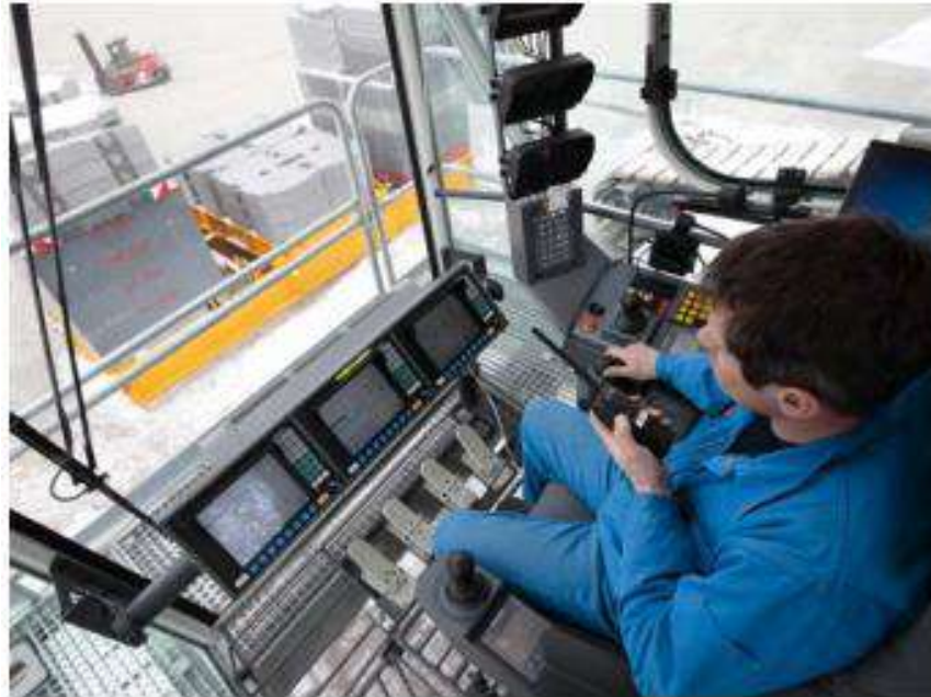
Рисунок 12.10 - Дубльована система керування краном
