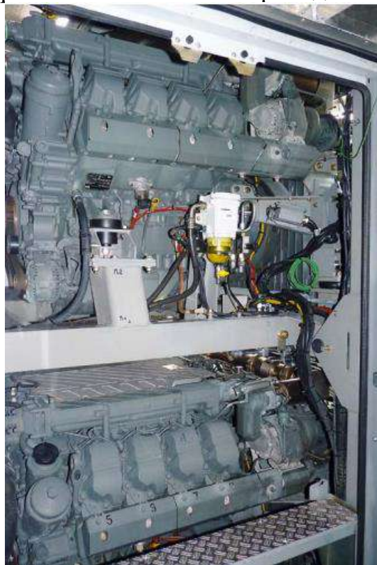
Рисунок 12.11 – Дубльований привід крана
