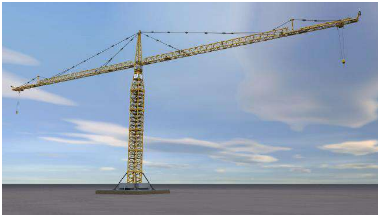
Рисунок 10.33 - Баштовий кран фірми «GG Tower Crane» з двома стрілами
