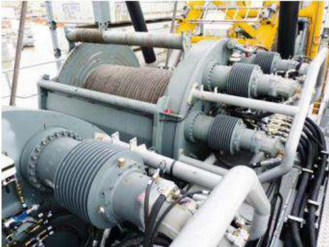
Рисунок 12.12 - Лебідки з окремими незалежними приводами
