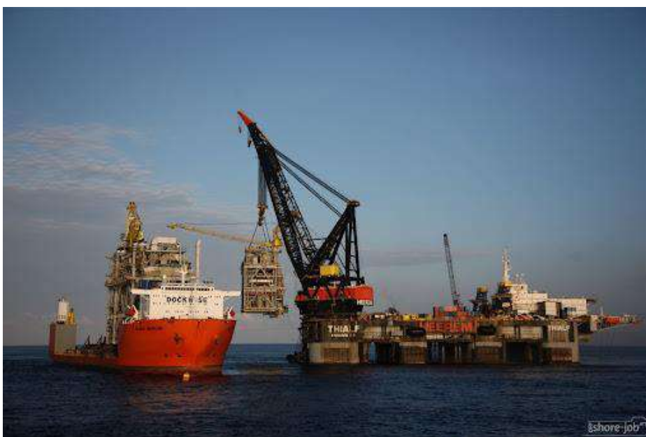
Рисунок 14.24 – Плавучий кран SSCV «Thialf» виконує унікальні підйомні операції
