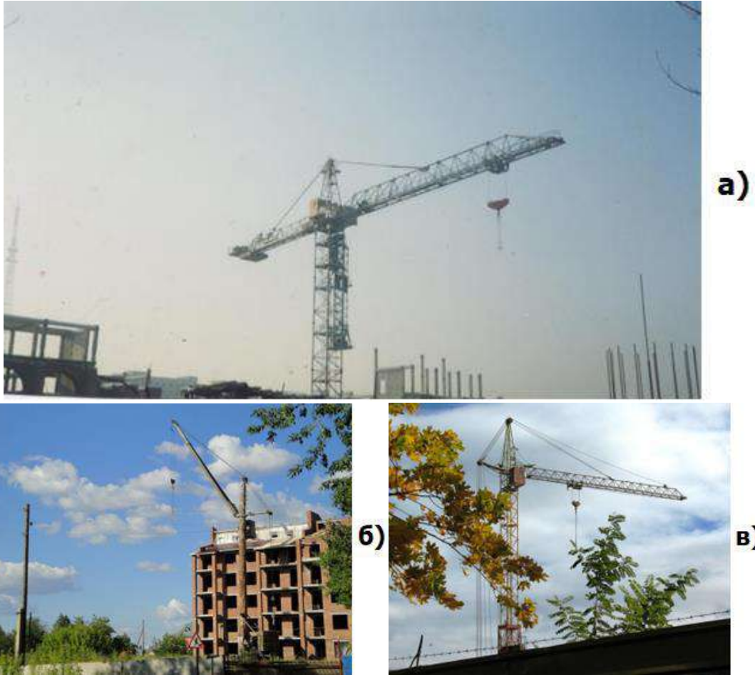
а) кран ґратчастої конструкції; б) кран з монотруб; в) баштовий кран КБ-401
