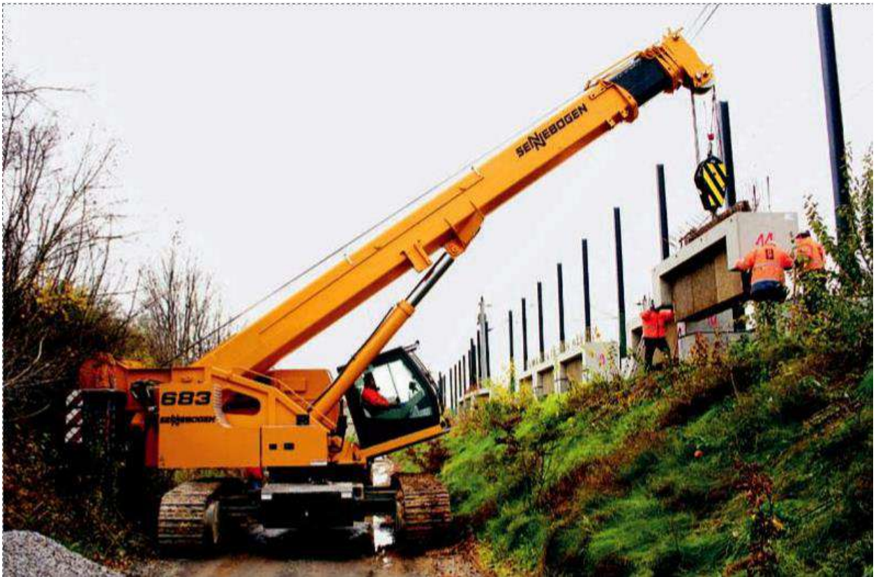
Рисунок 12.15 – Гусеничний кран с телескопічною стрілою
