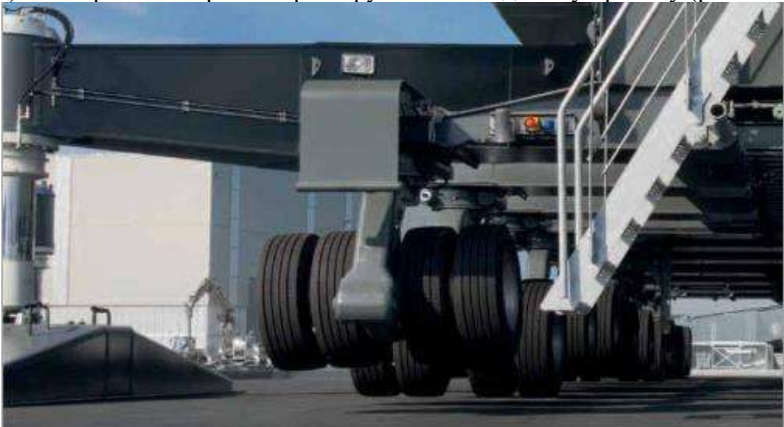
Рисунок 9.28 – Звільнення шасі від навантаження шляхом підйому крана на аутригерах
