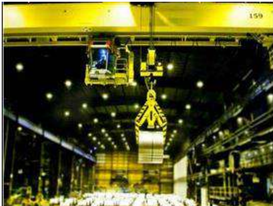
Рисунок 4.29 – Мостовий кран з автоматичними кліщами для передачі рулонів сталі
