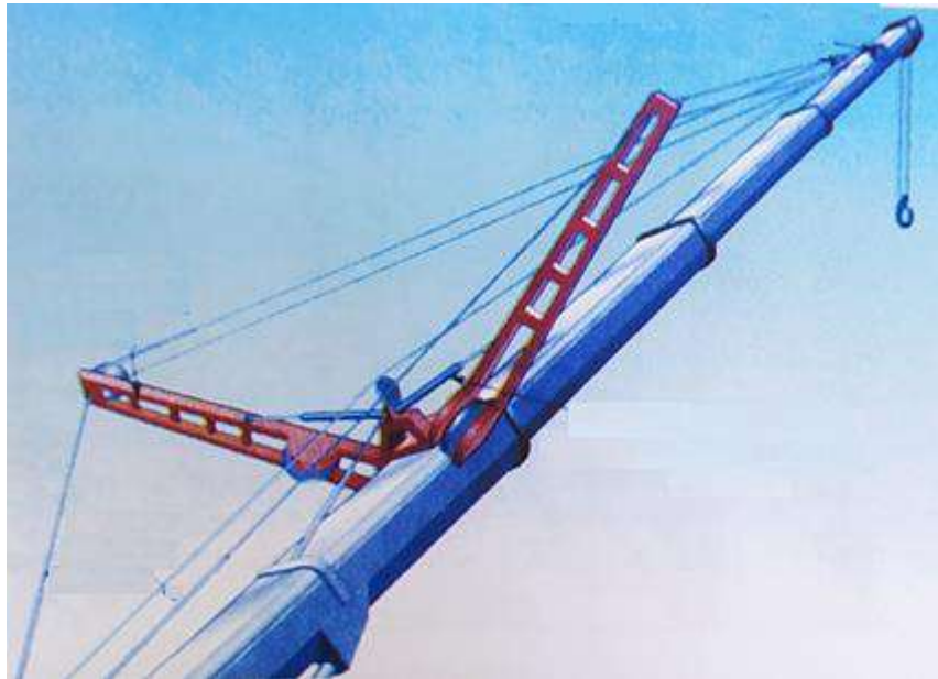
Рисунок 11.12 - Пристрій збільшення вантажопідйомності стріли
