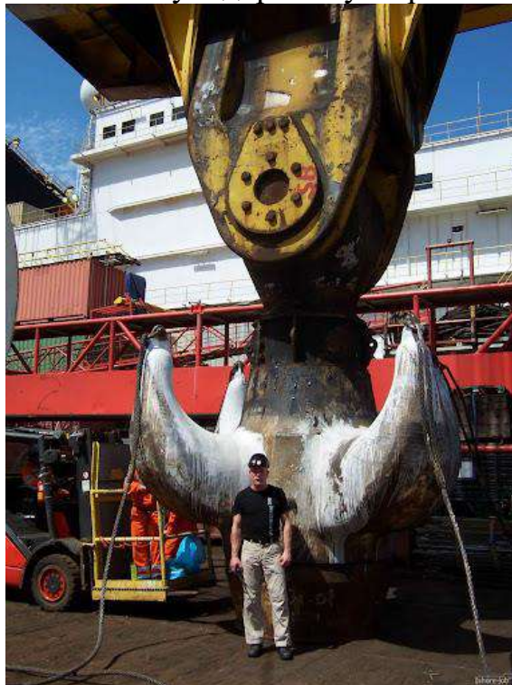
Рисунок 14.27 - Величезний багатотонний гак SSCV "Thialf"
