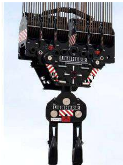
а) зручне баластування зі спредером; б) модульна гакова підвіска Рисунок 12.9 – Особливості крана LR 13000
