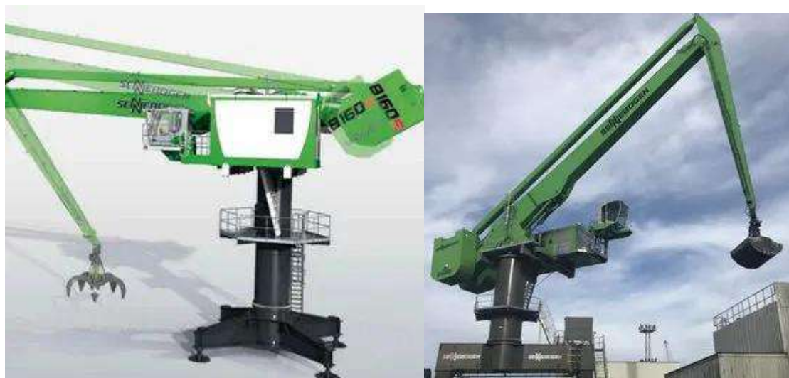
Рисунок 9.42 - Використання баланс-кранами багатощелепного та двощелепного грейферів
