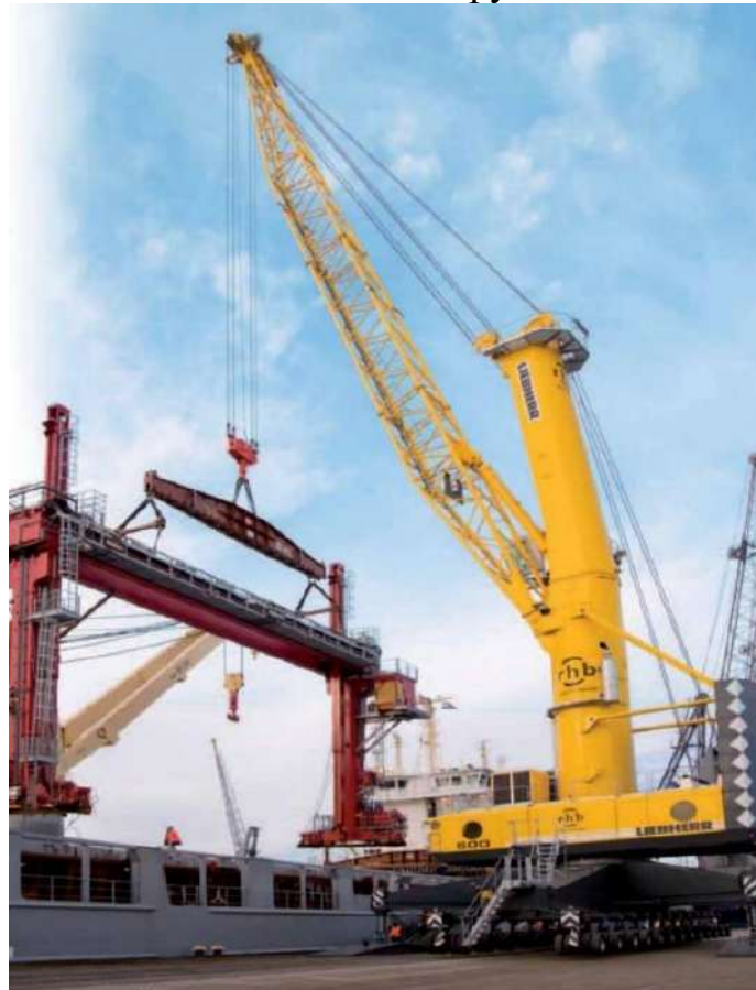
Рисунок 9.24 - LHM 600 RNB при перевантаженні важких крупногабаритів
