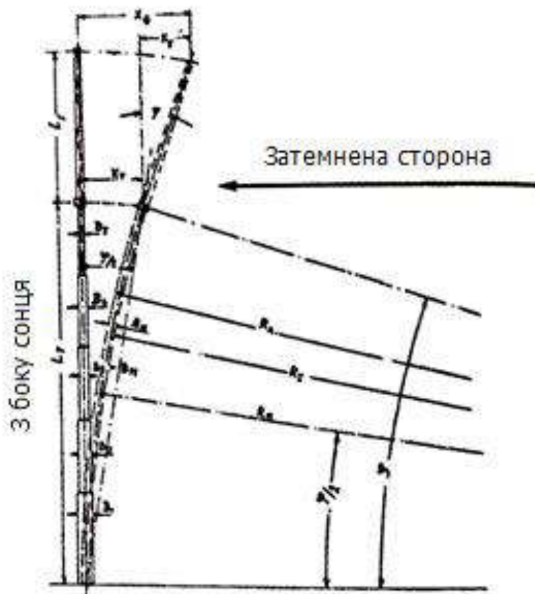
Рисунок 11.15 – Згин стріли при односторонньому нагріванні
