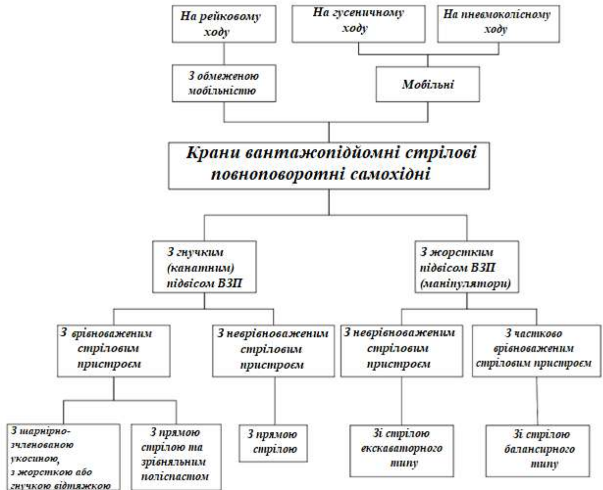
Рисунок 9.26 – Класифікація основних типів повноповоротних стрілових самохідних кранів
