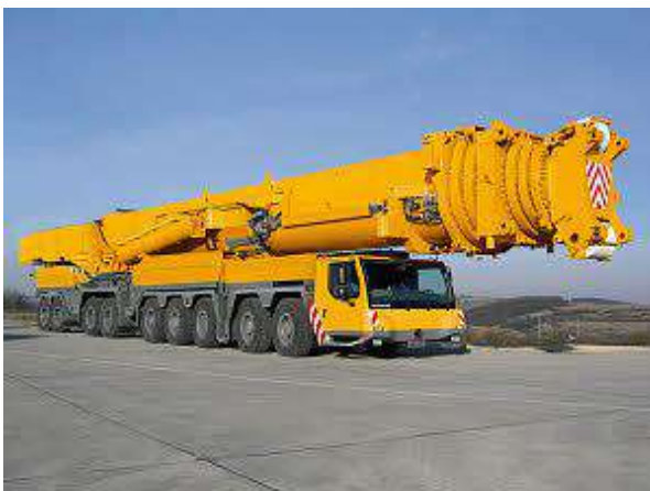
Рисунок 11.28 - Liebherr LTM 11200-9.1 "Мамонт" - самохідний телескопічний кран
