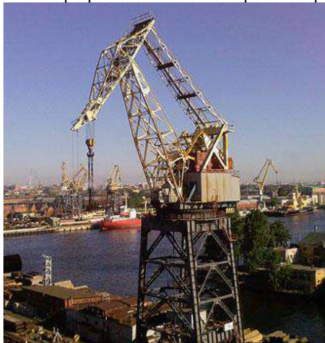
Рисунок 9.12 - Приклад шарнірно-зчленованої стріли з жорсткою відтяжкою
