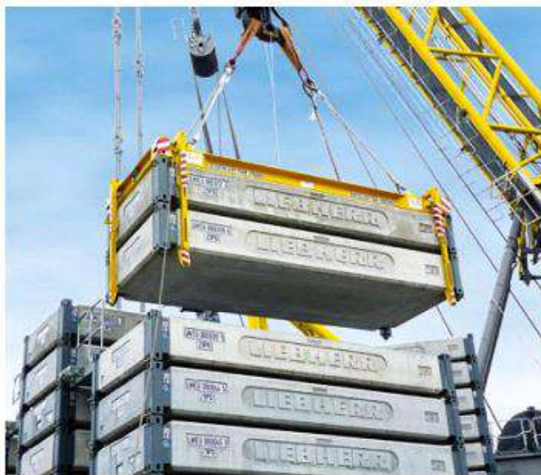
а) зручне баластування зі спредером; б) модульна гакова підвіска Рисунок 12.9 – Особливості крана LR 13000
