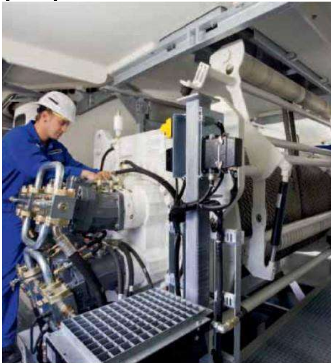
Рисунок 9.29 - Вантажні лебідки – аксіально-поршневі гідравлічні двигуни та канатний барабан
