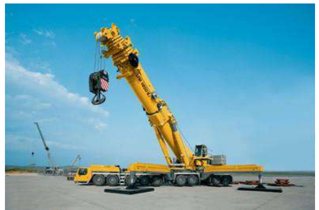
Рисунок 11.28 - Liebherr LTM 11200-9.1 "Мамонт" - самохідний телескопічний кран
