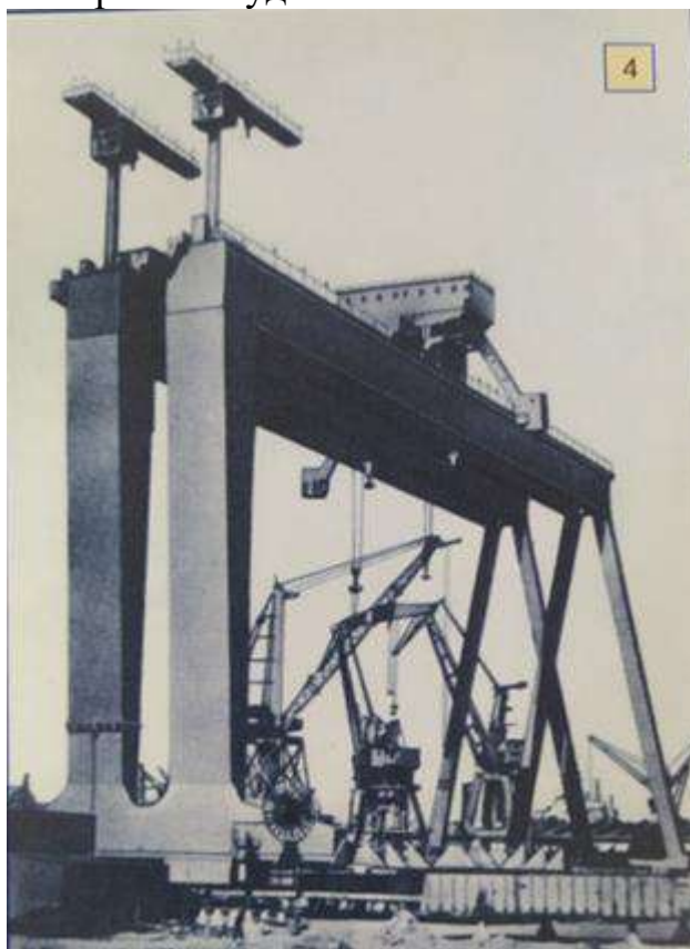
Рисунок 7.12 – Докові однобалкові козлові крани Q = 480 т, прогін – 115 м, висота підйому – 68 м
