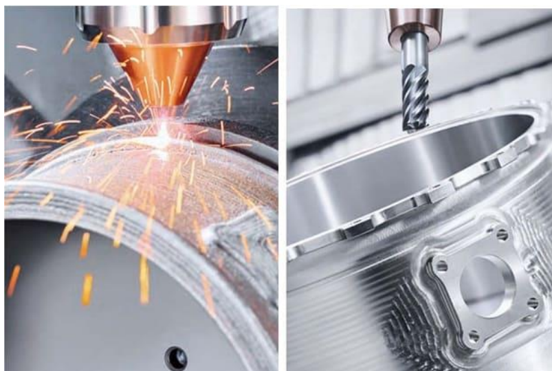
Рисунок 1.1 – Виготовлення деталей за допомогою гібридного виробництва [1]
