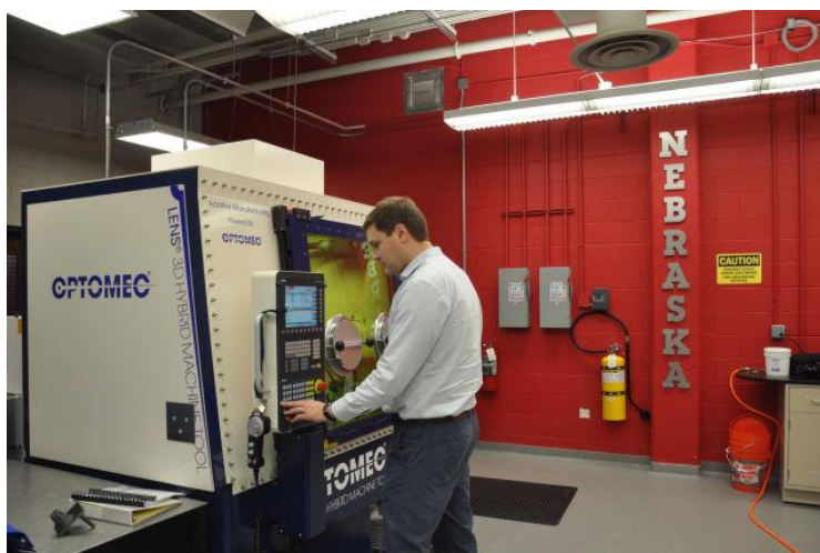
Рисунок 1.6 – Гібридна машина Optomec для виробництва біорозкладних медичних імплантатів [1]
