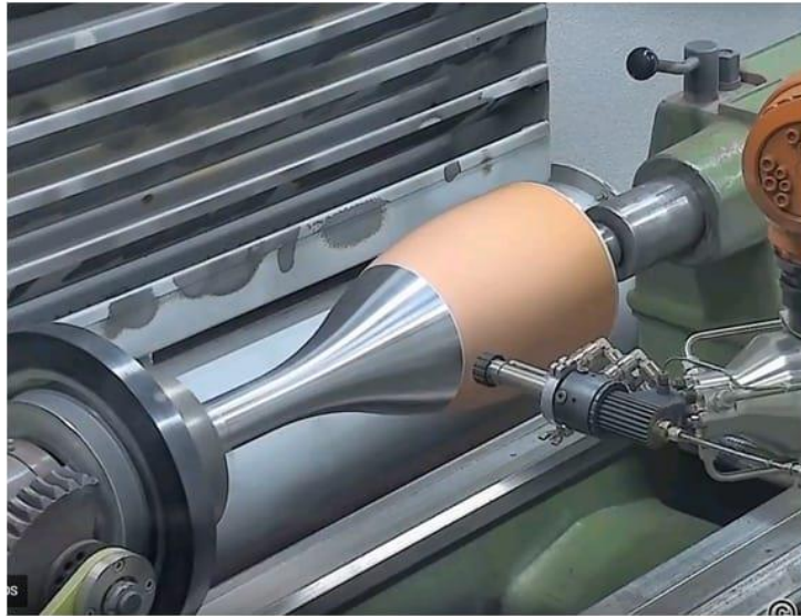
Рисунок 1.11 – Холодне напилення міді на оправлення
