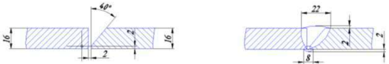
Рисунок 2.6 - Стикове з'єднання С12
