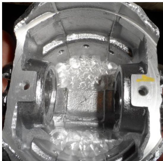
Рисунок 2.3 – Поршень MeMZ-307 після ручної механічної обробки для зниження маси
