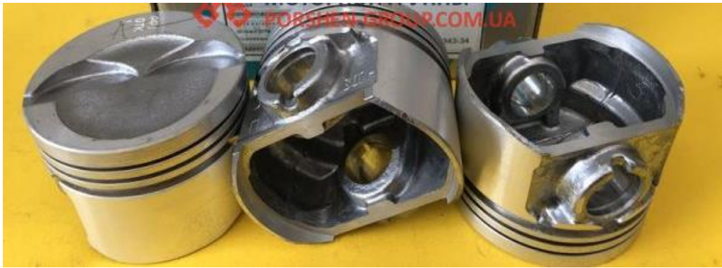
Рисунок 2.3 – Поршні MeMZ-307 з Т-подібними юбками
