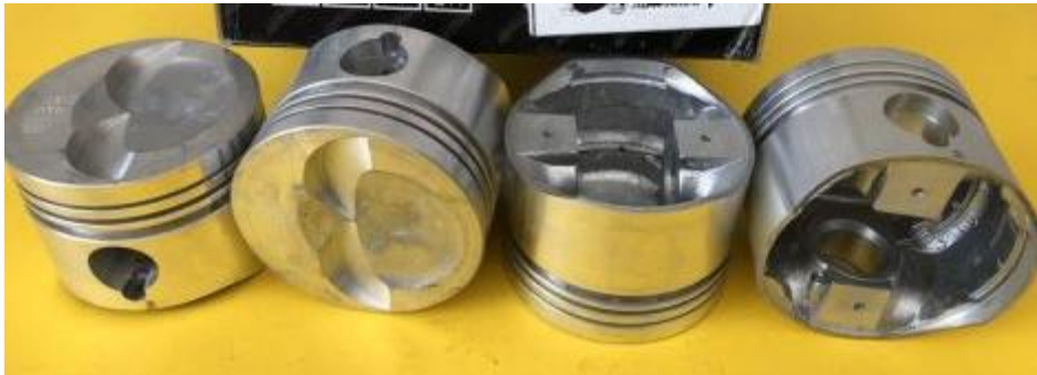
Рисунок 2.2 – Стандартний поршень MeM3-307 з циліндричною юбкою
