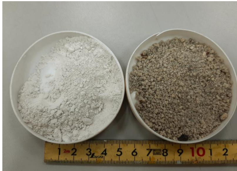
Рисунок 5.2 – Зразки гранульованого доменного шлаку: подрібнений (зліва, тонкий порошок – шлакове в'язуче) і гранульований (справа, крупинки перед помелом). Вода швидко охолоджує розплав шлаку, утворюючи аморфне «скло» світло-сірого кольору
