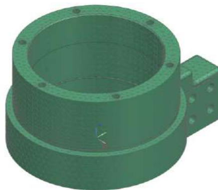
Рисунок 2.8 – Модель деталі, розбита на сітку кінцевих елементів
