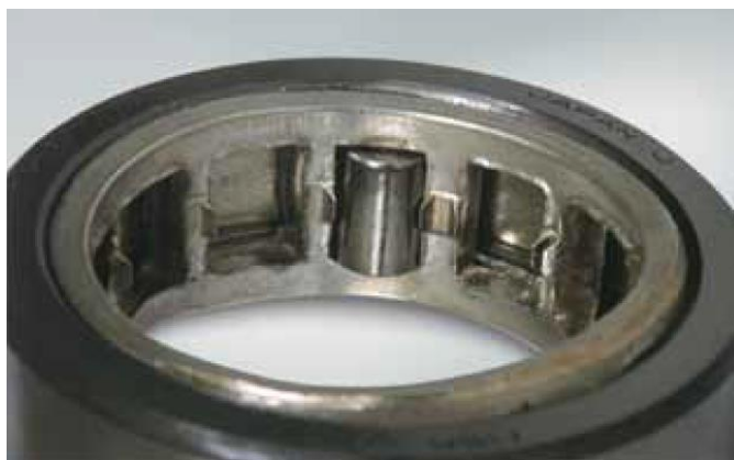
Рисунок 2.27 – Сепаратор циліндричного роликopідшипника
