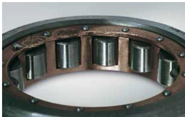
Рисунок 2.24 – сепаратор циліндричного роликотепідшипника
