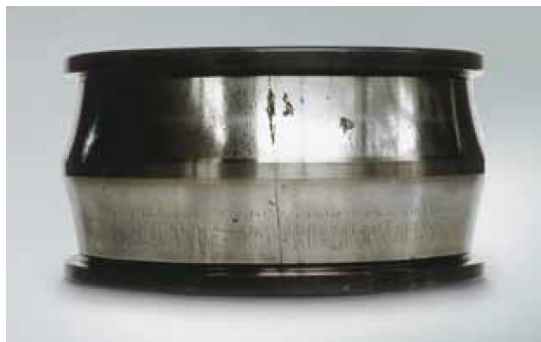
Рисунок 2.20 – Внутрішнє кільце сферичного роликпідшипника
