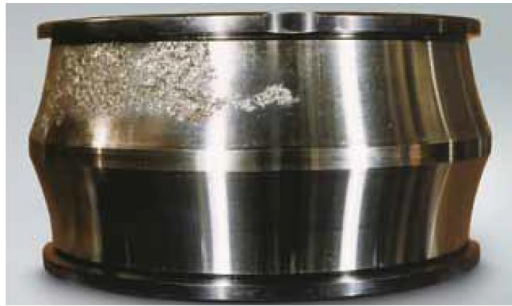
Рисунок 2.29 – Внутрішнє кільце сферичного роликopідшипника
