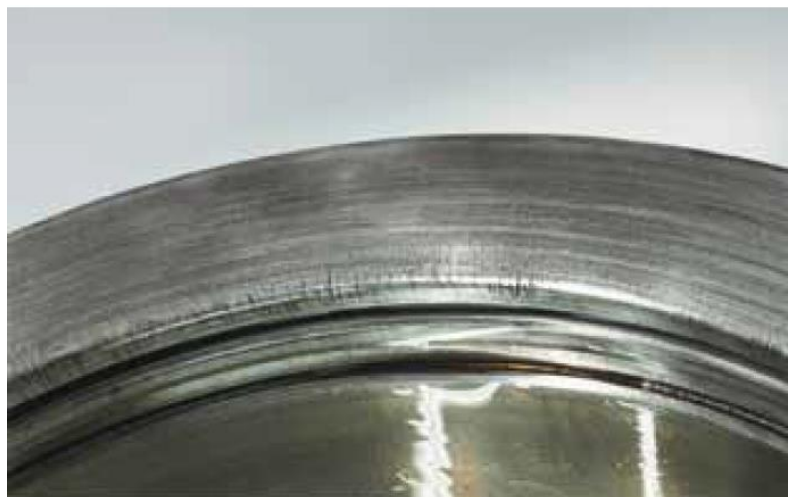
Рисунок 2.22 – Внутрішнє кільце сферичного роликопідшипника
