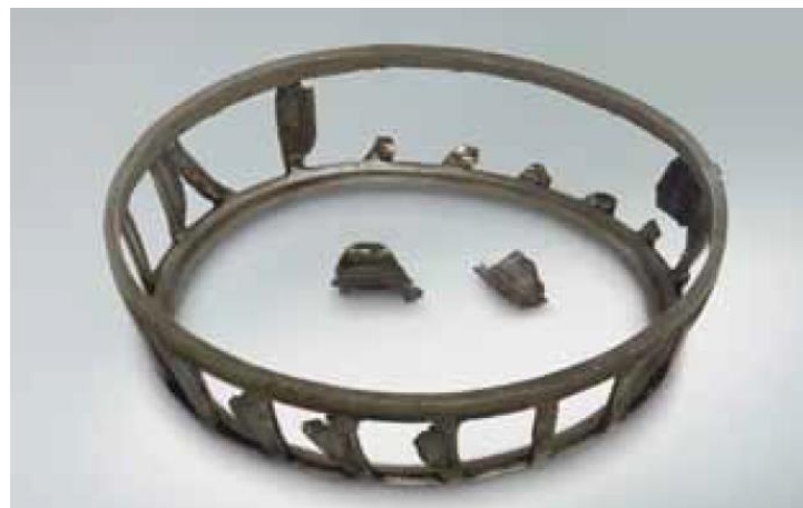
Рисунок 2.26 – Сепаратор конічного роликопідшипника
