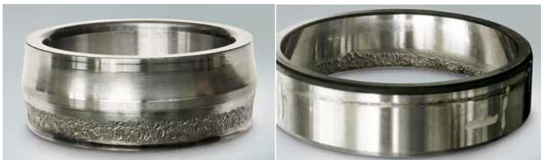
Рисунок 2.28 – Внутрішнє та зовнішнє кільця сферичного роликopідшипника
