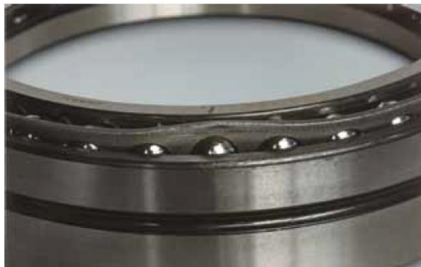
Рисунок 2.23 – сепаратор радіально - упорного шарикотепідшипника
