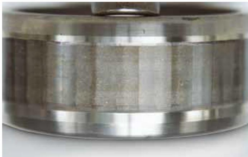
Рисунок 2.18 – Внутрішнє кільце підшипника
