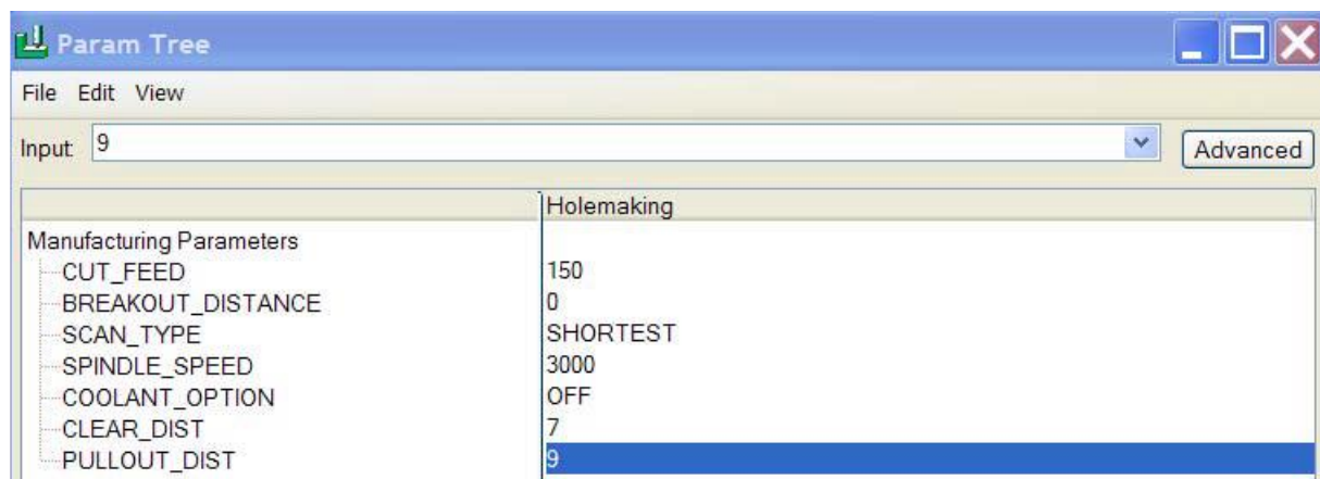
Рисунок 3.10 – Корегування параметрів операції свердління
