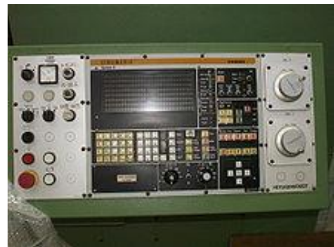
Рисунок 1.2 – Контролери (а) та панель управління верстата з ЧПУ
