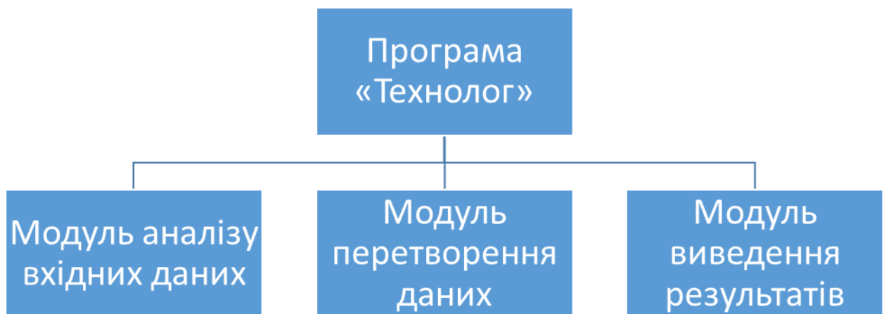
Рисунок 3.2 – Структура програми «Технолог»
