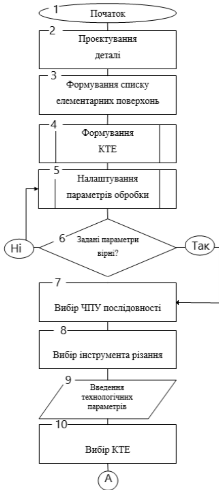
Рисунок Б.1 – Схема алгоритму автоматизованої технологічної підготовки механічної обробки, аркуш 1
