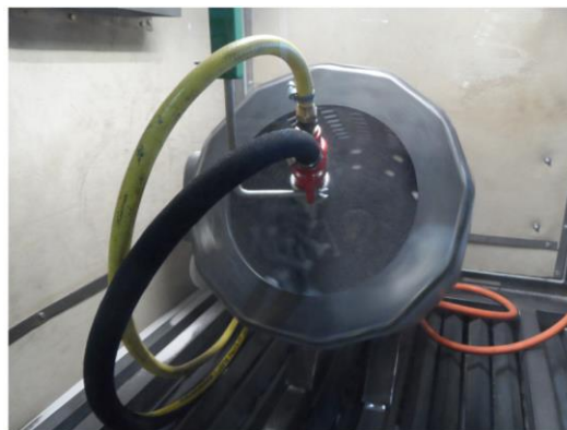
Рисунок 4.8 – Дробеструйна установка з галтувальним барабаном.
