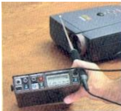
Рисунок 4.3 – CPM-700 з РЧ-зондом у роботі
