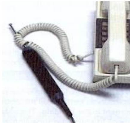
Рисунок 4.5 – Перевірка телефонного апарату з допомогою РЧ-зонду
