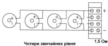
Рисунок 5.5 – Паралельне з'єднання перетворювачів
