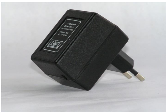
Рисунок 4.9 – Тестовий передавач для передачі сигналів по мережі живлення CCT-700
