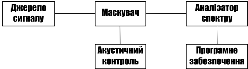
Рисунок 6.11 - Функціональна схема робочого місця для дослідження маскувача мовних сигналів.
