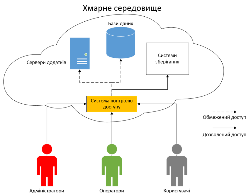
Рисунок 3.8 – Схема централізованого контролю доступу
