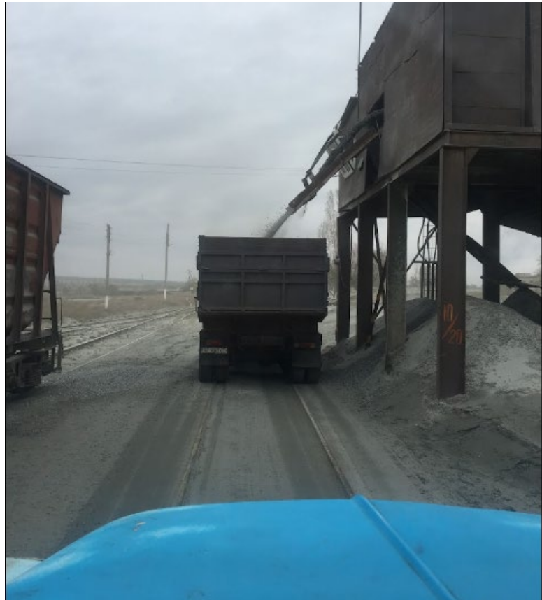
Рисунок 1.2 – Приклад завантаження автомобільного транспорту щебнем
