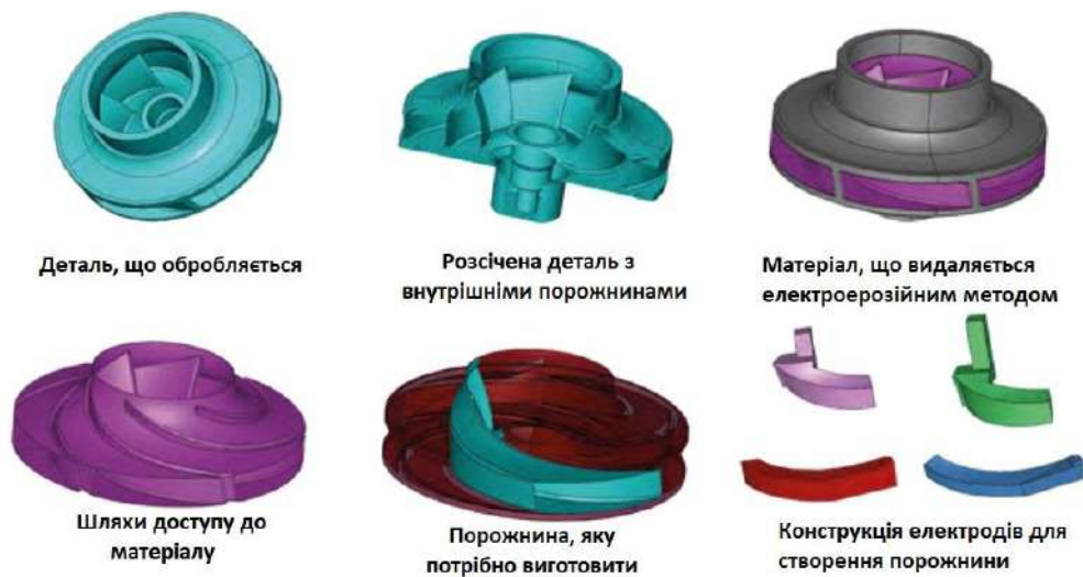
Рисунок 5.8 – Зображення індивідуальної програми від ONA для обробки робочих коліс [11]
