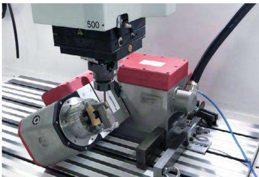
Рисунок 4.3 – Обробки дифузорних отворів зі складною геометрією в лопатках турбіни на верстаті ONA IRIS6 [11].
