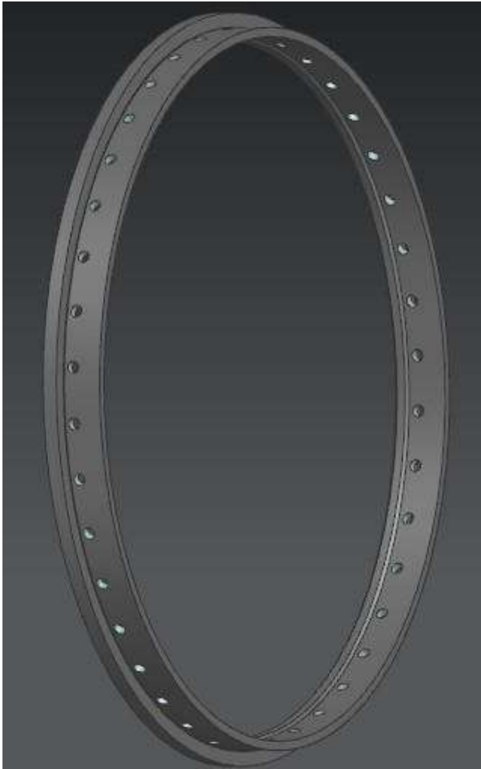
Рисунок 1.15 – 3D-оперативний ескіз свердильної операції 045.
