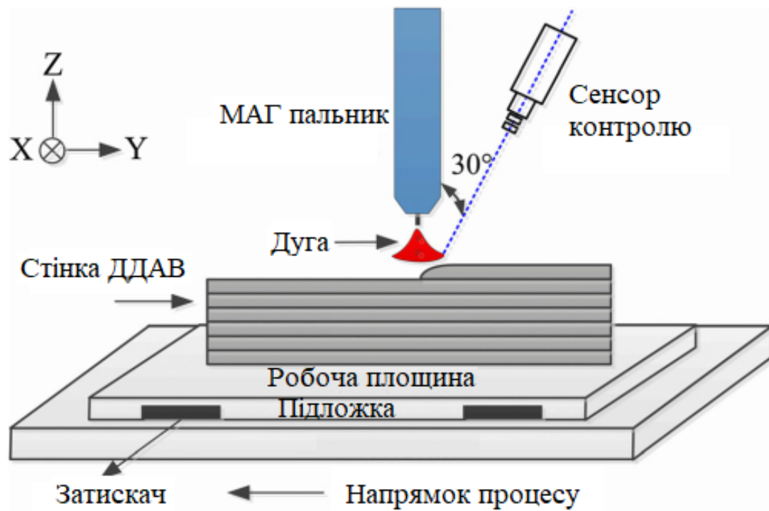
Рисунок 1.17 – Принципова схема ДДАВ-процесу на основі МАГ процесу [26]
