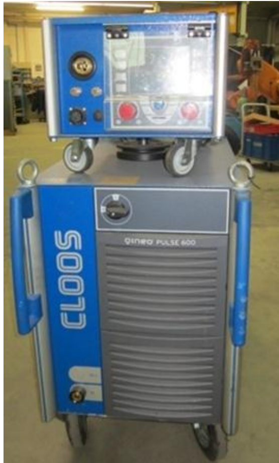
Рисунок 4.4 – Джерело живлення QUINEO*PULSE-450
