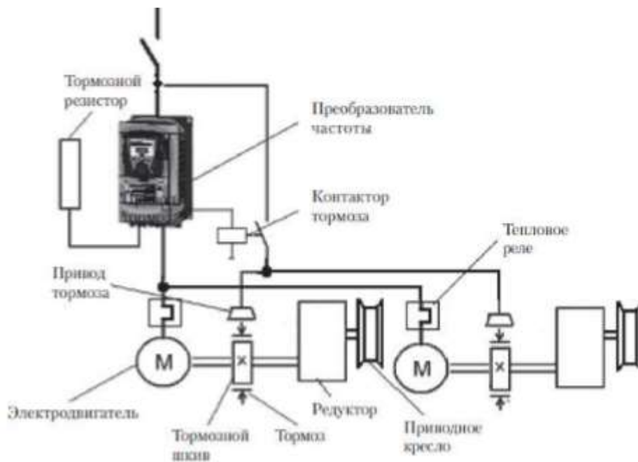
Рис. 6.4 Структурна схема електроприводу механізму пересування.
