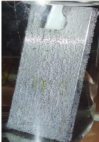
Рисунок 3.1 – Виділення пухирців газу на зразку
