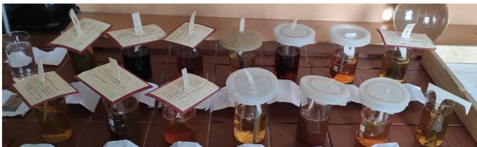
Рисунок 2.5 – Витримка зразків в корозійноактивних середовищах з інгібіторами
