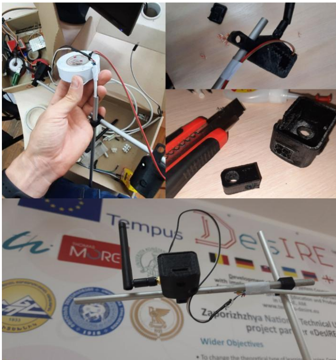
Рисунок В.2 – Розробка кріплення для блоку захоплення і трансляції відеозображення
