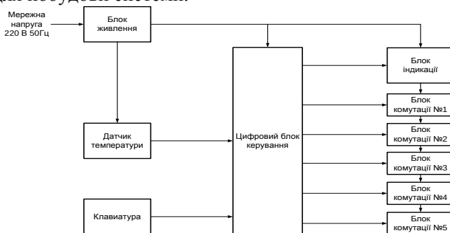
Рисунок 1 – Схема структурна автоматизованої системи підтримки мікроклімату акваріума
