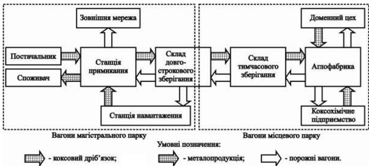
Рисунок 2.2 – Схема вагонопотоків при перевезенні коксового дріб'язку
