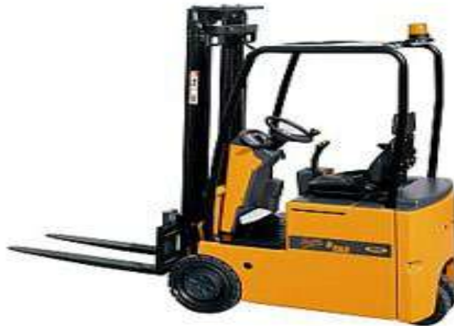
Рисунок 2.9 – Фронтальний трьохколісний електронавантажувач марки OMG ERGOS 10 TA3
