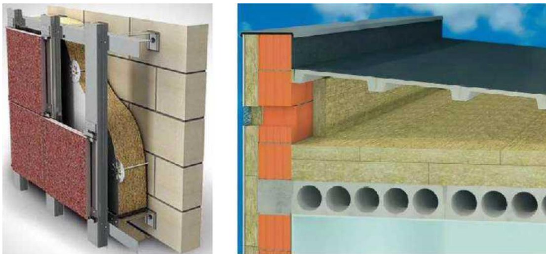
Рисунок 6.10.1 – Вентильована стіна та перекриття
