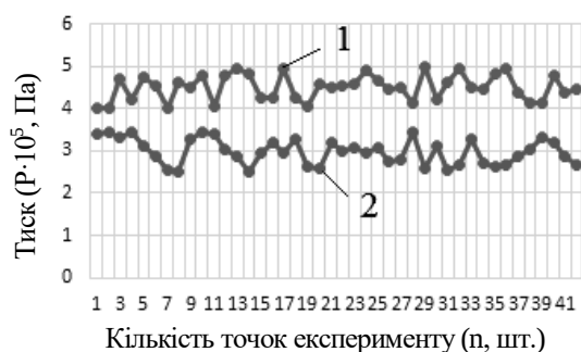
Рисунок 2 – Експериментальні дані: тиск на вході (1) і виході (2) пневмотранспортної системи
