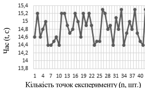
Рисунок 4 – Час реакції системи на зміну тиску
