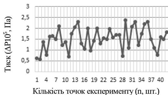
Рисунок 3 – Втрати тиску між входом і виходом пневмотранспортної системи
