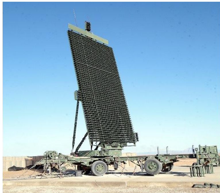
Рисунок 3.32 – Зовнішній вигляд РЛС AN/TPS-59 (фото з інтернету Author: Roman Yurek, U.S. Marine Corps )
