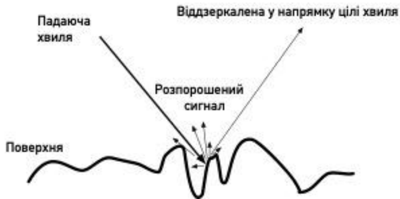
Рисунок 2.3 – Розпорошення енергії на нерівностях
