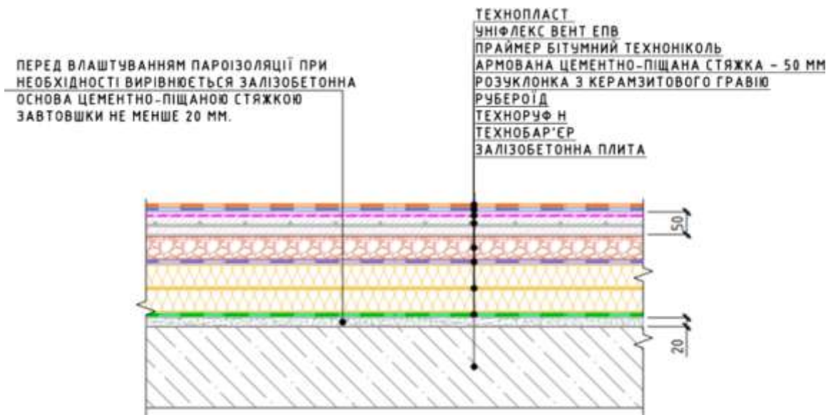
Рисунок 1.1 – Склад системи покрівлі
