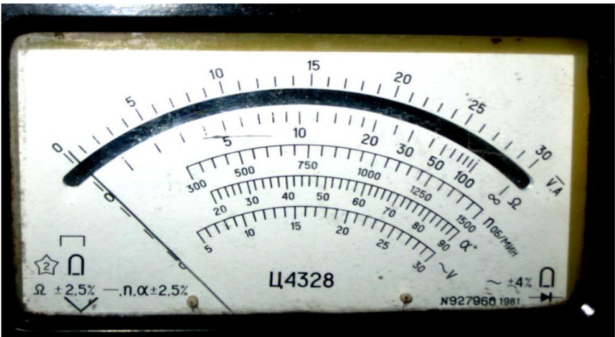
Рисунок 2.2 – Комбінований прилад Ц 4328 для вимірювання сили електричного струму, електричної напруги, електричного опору
