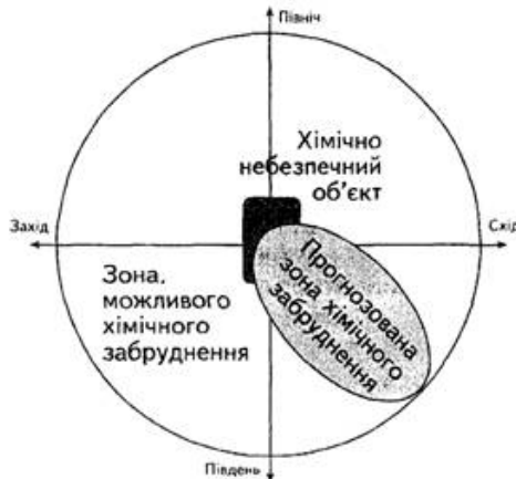
Рисунок 2.2 – Нанесення зон зараження НХР на схеми (карти)
