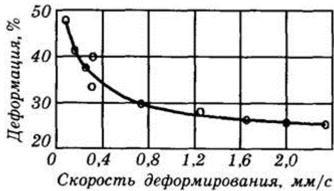
Рисунок 1.1 - Залежність граничної деформації сірого чавуну при осаджуванні від швидкості деформування
