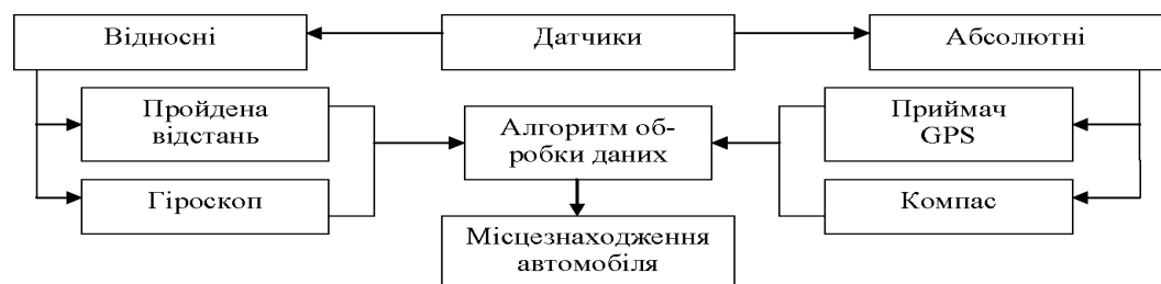
Рисунок 3.4 – Системи і датчики визначення місцезнаходження автомобіля
