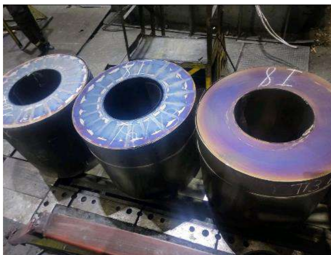
Рисунок3.13 Зовнішній вид рулонів, при відпалі яких під муфель печі попав кисень
