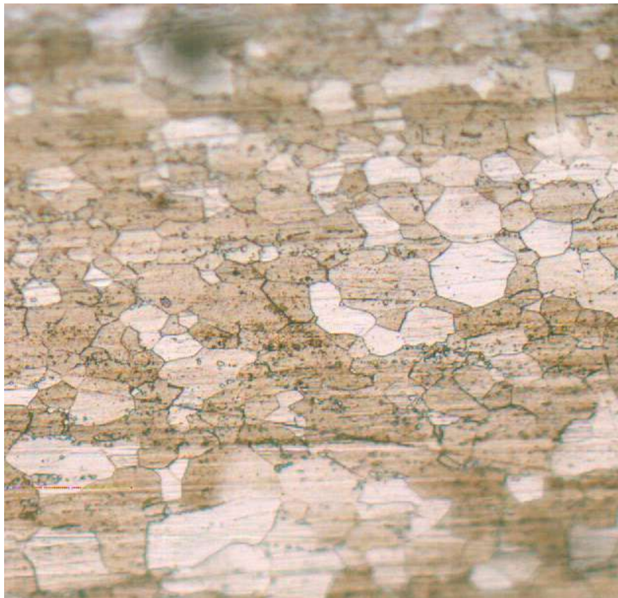
Різнотермісткість проката сталі DX51D, отримана при довготривалому відпалі.
