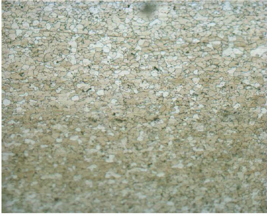
Структура відпаленого прокату рекристаллизоване зерно феррита
