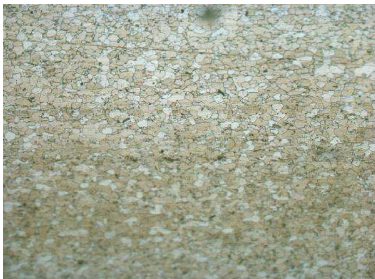
Рисунок 3.9- Структура відпаленого прокату – рекристалізоване зерно феррита ( \times 200 )
