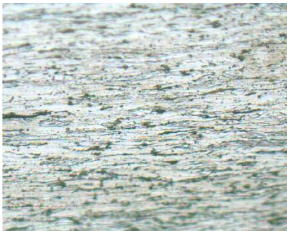
Рисунок3.5- Структура холоднокатаного (нагартваного) прокату - нерекрісталізоване зерно фериту - текстура ( \times 200 )
