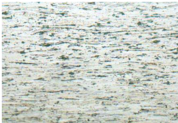
Рисунок3.6- Структура холоднокатаного (нагартваного) прокату - нерекрісталізоване зерно фериту - текстура ( \times 200 )
