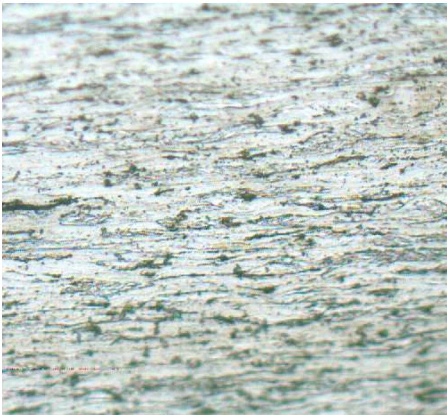
Структура холоднокатаного (нагартваного) прокату – нерекрісталізоване зерно фериту - текстура
