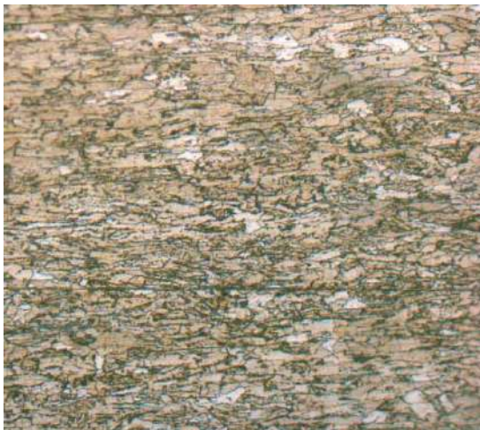
Рисунок3.14 - Голчасте зерно недовідпаленого прокату при збільшенні ( \times 200 )
