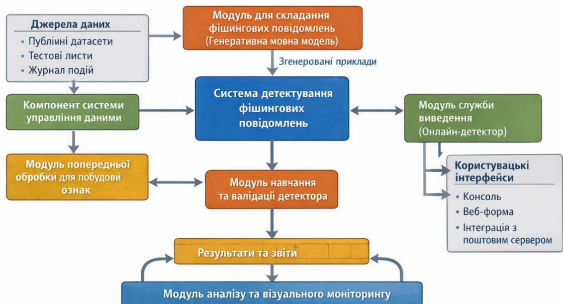
Рисунок 3.1 – Узагальнена модульна архітектура системи детектування фішингових повідомлень
