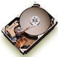
Рис. 1. Жорсткий диск зі знятою кришкою корпусу.
