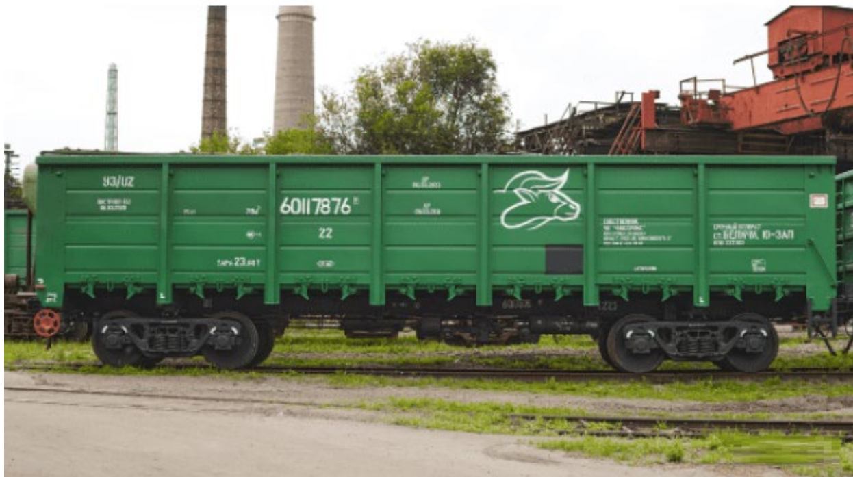
Рисунок 2.3 - Піввагон люковий моделі 12-4106-01 виробництва Дніпровагонмаш
