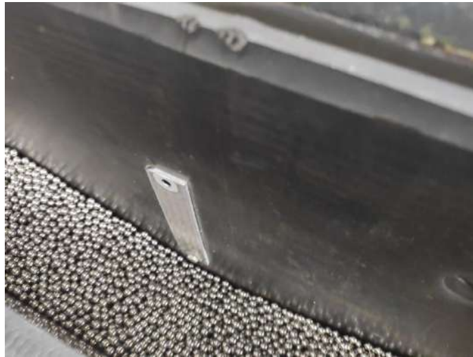
Рисунок 2.2 – Зразок–свідок, закріплений на деталі
