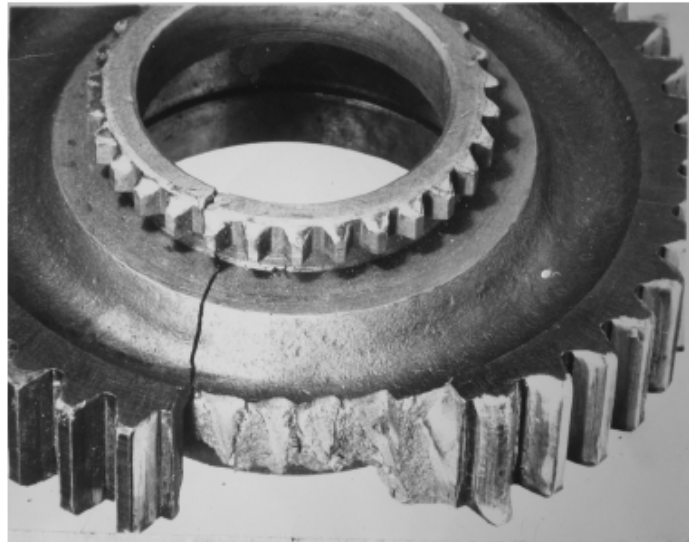
Рисунок 4.8 – Різні види ушкоджень шестерні внаслідок заниженої глибини нітроцементованого шару; \times 1/4
