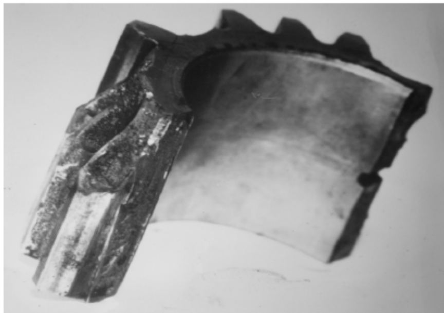
Рисунок 4.7 - Руйнування шестерні із-за заниженої глибини нітроцементованого шару; \times 1/2
