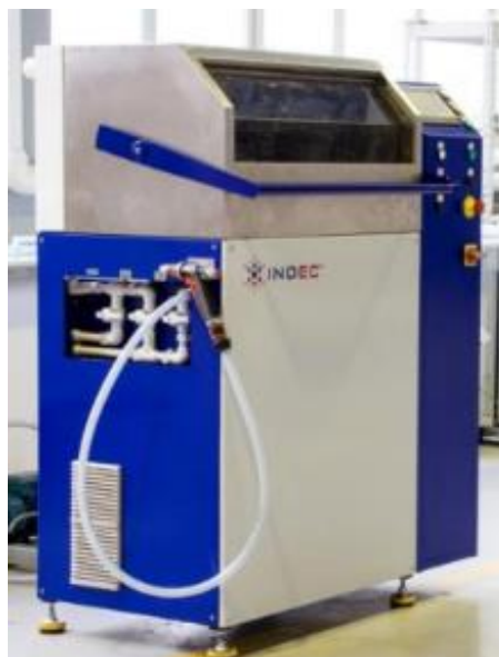
Рисунок 5.3 – Електрохімічний верстат для видалення задирок фірми INDEC
