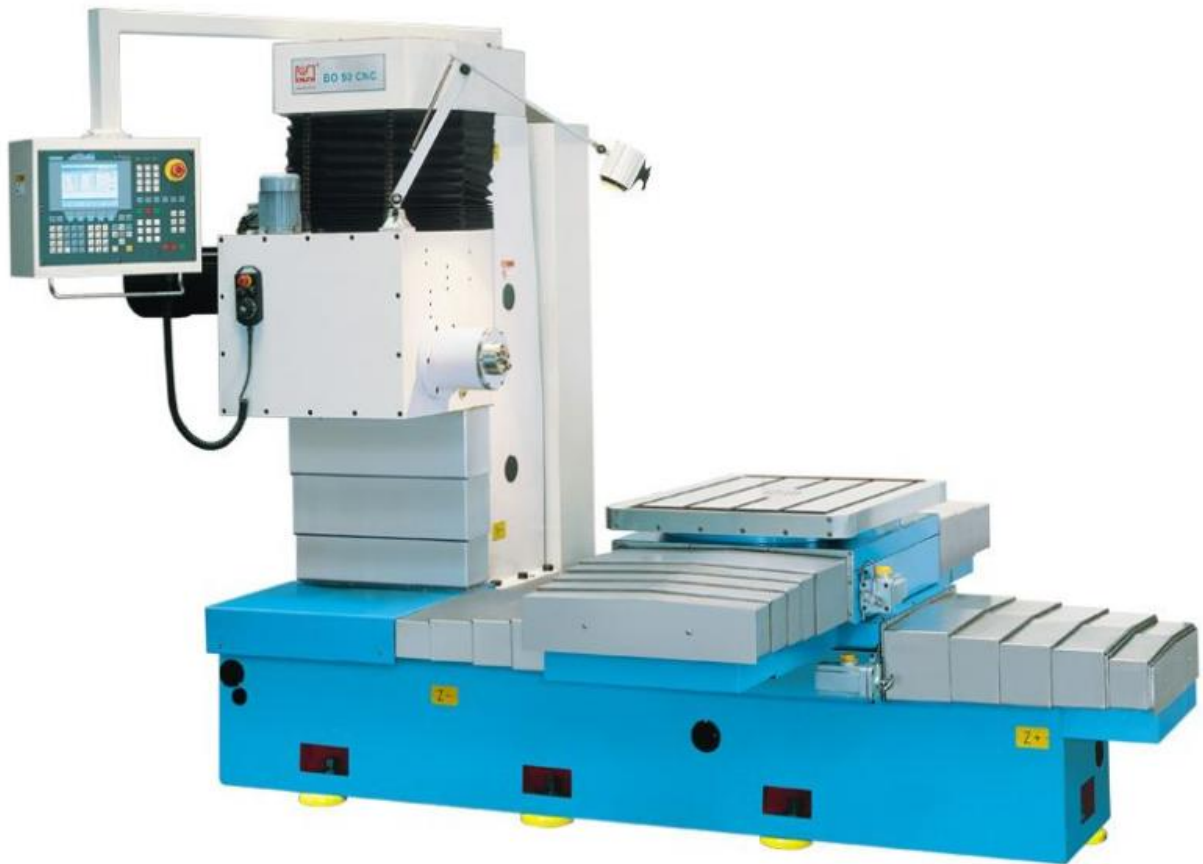
Рисунок 3.2 – Горизонтально-розточний верстат з ЧПК ВО 90 CNC
