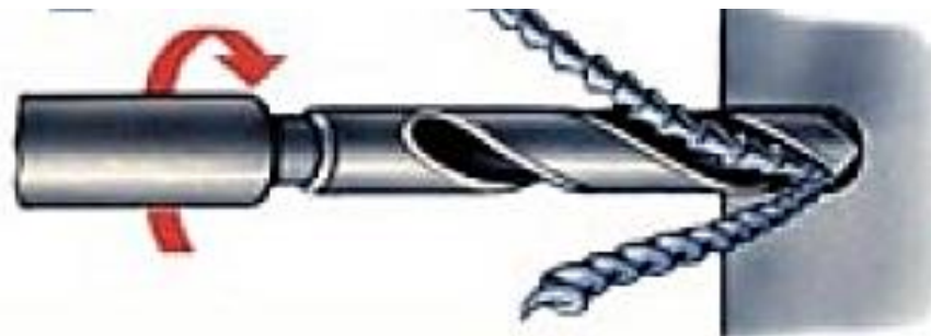
Рисунок 3.1 – Утворення зливної стружки при свердленні в'язких металів
