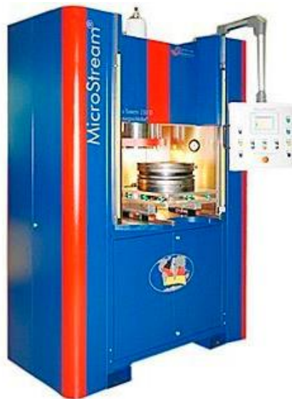
Рисунок 5.2 – Термічний верстат для видалення задирок фірми MICROSTREAM
